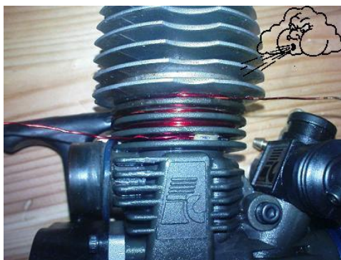
5. ábra Léghűtés alkalmazása egyszerűbb motorok esetén
